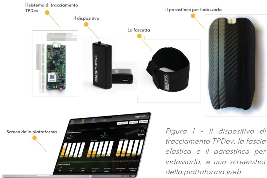
Figura 1 - Il dispositivo di tracciamento TPDev, la fascia elastica e il parastinco per indossarlo, e uno screenshot della piattaforma web.
